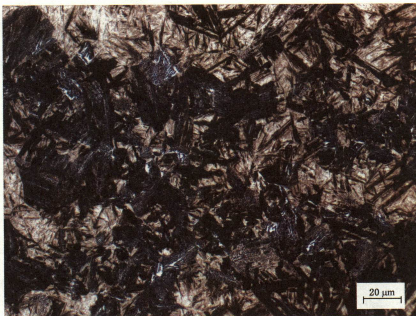
图8 马氏体+条块状铁素体(铁素体含量 \geq 10\% ),8级
