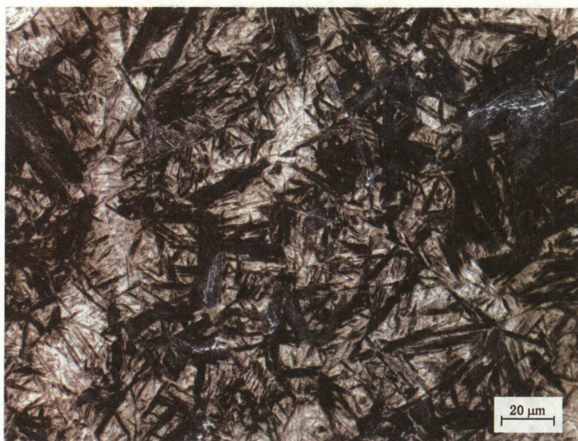
图 7 马氏体+少量铁素体( 5\% \leq 铁素体含量 <10\% ), 7 级
